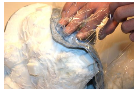
Fig. 17. De eerste schijf epoxy wordt op de siliconen gelegd en goed aangeduwd.
