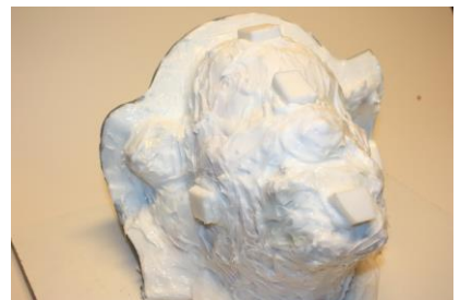
Fig. 10. Op een aantal logische plaatsen zijn siliconen sleutels aangebracht.
