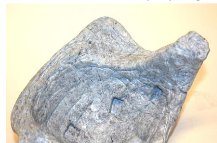
Fig. 20. De binnenkant van de steunkap. De siliconen- sleutels zijn duidelijk zichtbaar.
