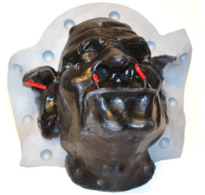
Fig. 5. Beide snijtanden worden voorzien van ontluucht-kanalen. Vanuit het puntje van het rechter oor loopt een kanaal dat niet alleen als ontluchting fungeert maar tevens ter versteviging tijdens het ontmallen.
