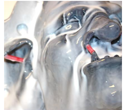
Fig. 6. Het complete model (inclusief de plasticine rand) is voorzien van een, uiterst dunne, eerste laag siliconen.
