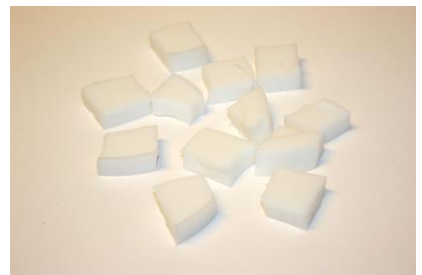
Fig. 9. Blokjes (sleutels) gesneden uit een cm dikke lap siliconen.
