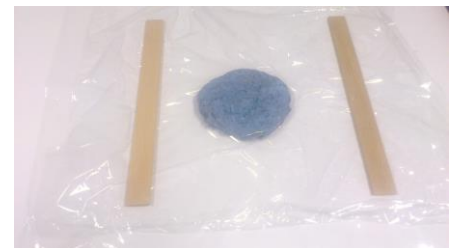
Fig. 13. De massa is goed gekneed en tussen twee lagen folie geplaatst. Links en rechts een latje van 3-4 mm dik.
