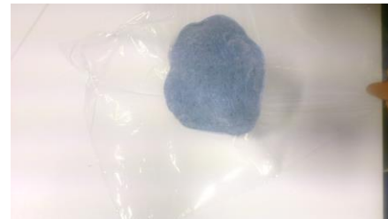
Fig. 16. De schijf epoxy wordt met het onderste folie opgetild.
